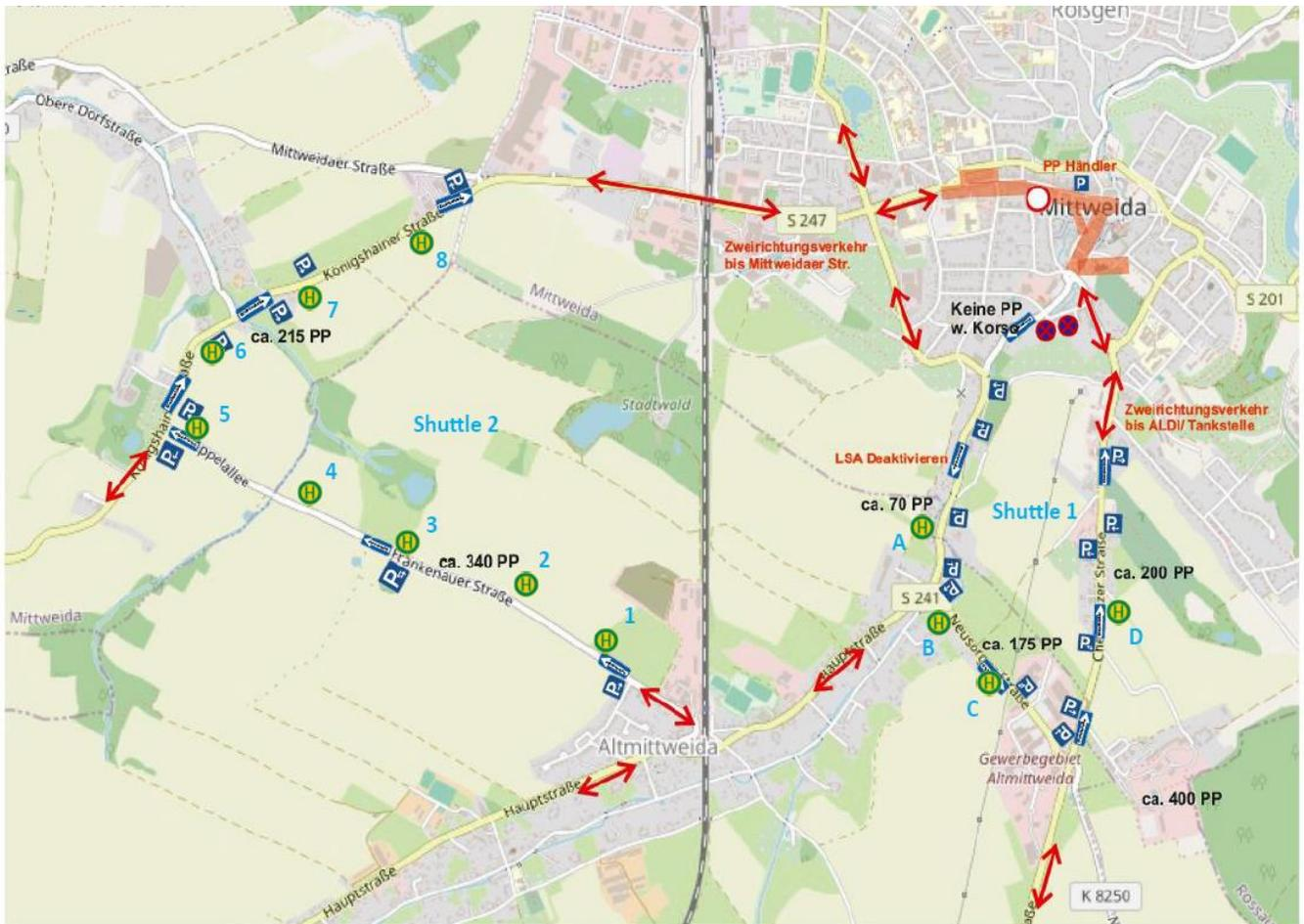
Einbahnstraßenregelung mit Parkanordnung auf Fahrbahn. Parkplatzzahl ist Längsaufstellung mit KFZ Länge 6m gerechnet. Bei Schrägaufstellung Parkplätze x1,5
